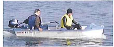
二馬力船外機装着・直進走行 ・オプションサイドフロート装備
