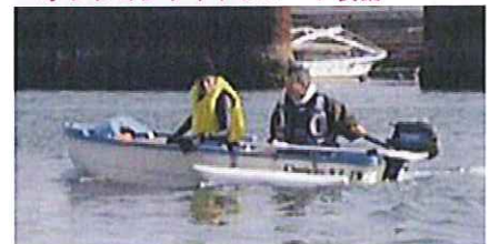
二馬力船外機装着・直進走行 ・オプションサイドフロート装備
